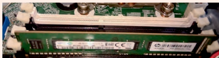
Fig. 2: Lock the RAM module
