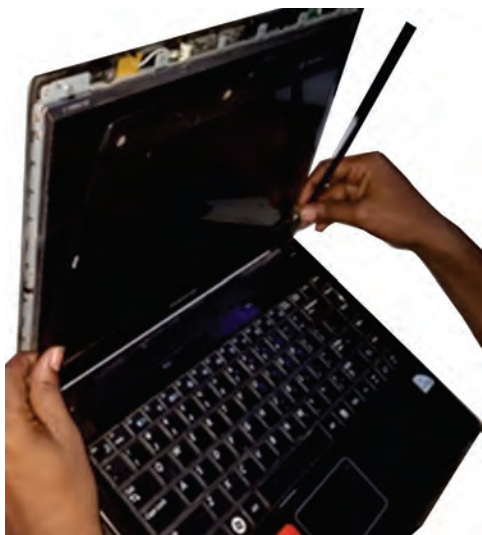
Fig. 12.78: Remove screen bezel
