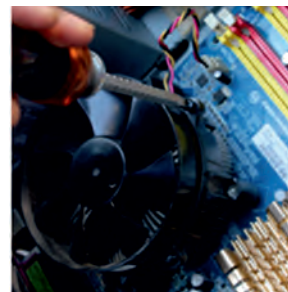
Fig. 12.43: Remove the system fan
