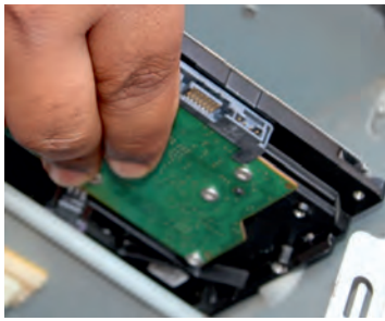
Fig. 12.12: Insert hard disk
