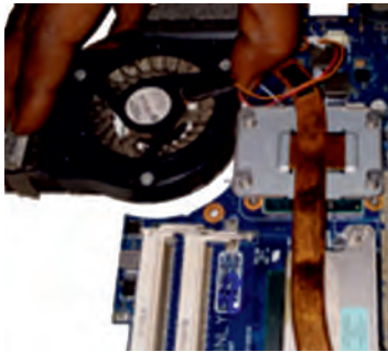
Fig. 12.68: Remove cooling fan
